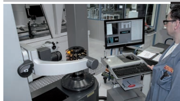
»hobCheck 800« von ZOLLER im Einsatz für die Qualitätskontrolle bei SANDVIK Tooling Supply Schmalkalden.
